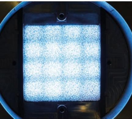
Zelluläre  $\text{TiO}_2$ -beschichtete Keramik unter UV-C-Bestrahlung in der Reaktionskammer.
